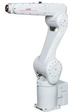
WWF recurrió al robot articulado de bajo costo y alto rendimiento RV-8CRL de Mitsubishi Electric, el cual les ha permitido hacer funcionar un torno CNC durante unas cuatro horas sin supervisión.
